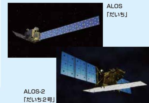
▲陸域観測技術衛星「だいち2号」(ALOS-2) は、「だいち」(ALOS) から地球観測ミッションを引き継いだ人工衛星で、2014年から稼働を開始しています。送られてくる観測データは、災害状況や森林分布の把握、地殻変動の計測など、様々な分野で利用されています。
