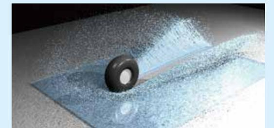
▲粒子法を用いた水跳ねのシミュレーション結果
