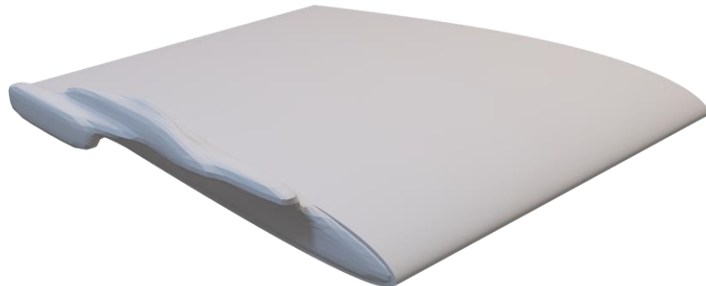
図 3: 得られた解形状の例（揚抗比が大きい解）
