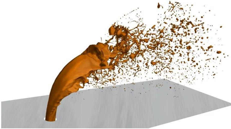
図 1: 大気圧下における微粒化詳細解析の結果
