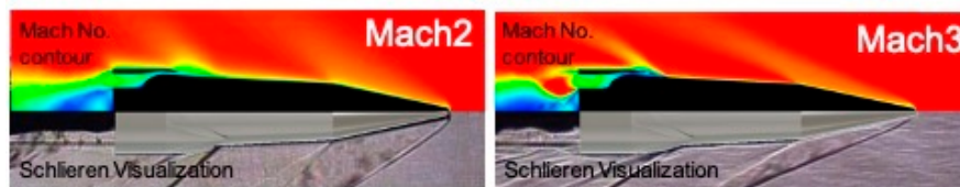
図 2: CFD 解析結果と風洞実験における流れ場の可視化結果の比較
