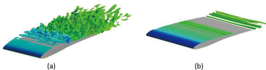
図 2: C_p で色付けした Q 値の等値面 ( -1.5 < C_p < 1.0 ) (瞬時場) (a) 表面移動法適用無し (b) 表面移動法適用有り
