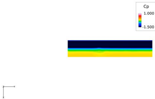
図 1 表面圧力係数の時間変動（後退角 0^\circ ）
