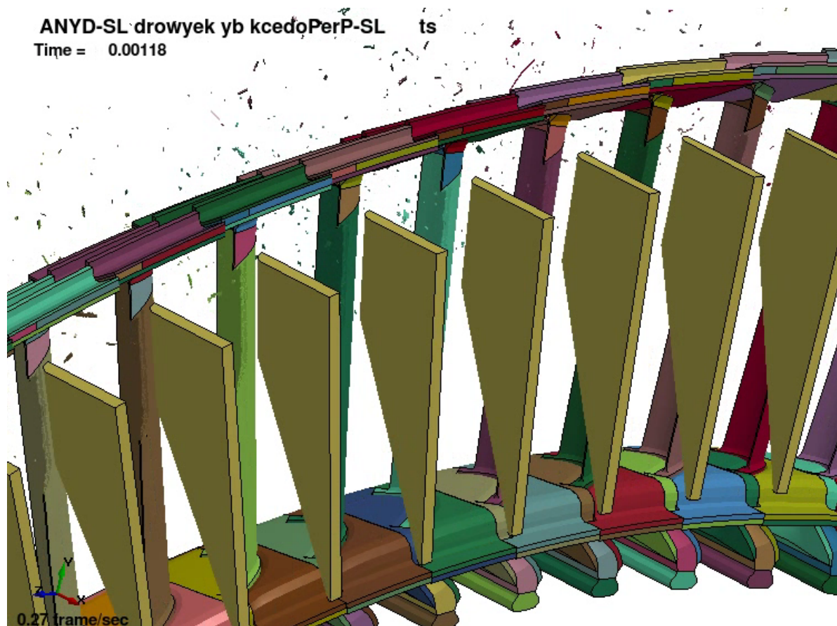
図 1 CMC 動翼列の破壊解析
