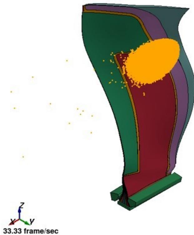
図3 中空複合材ファンブレードのバードストライク解析 (c)  $t = 1.2 \text{ ms}$
