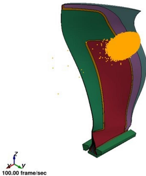
図2 中空複合材ファンブレードのバードストライク解析 (b)  $t = 0.9 \text{ ms}$
