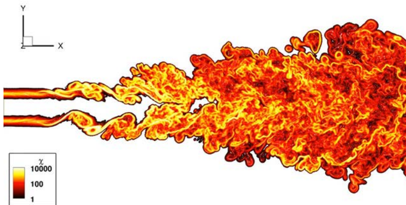
図 3 Re = 10^4 でのスカラー散逸率分布 ( z = 0 ) のムービー.
