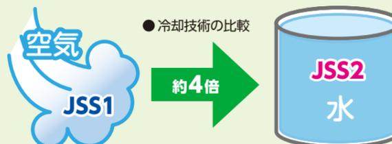
JSS1での空冷システムより高効率の水冷方式を採用することで冷却能力を約4倍向上させました。
