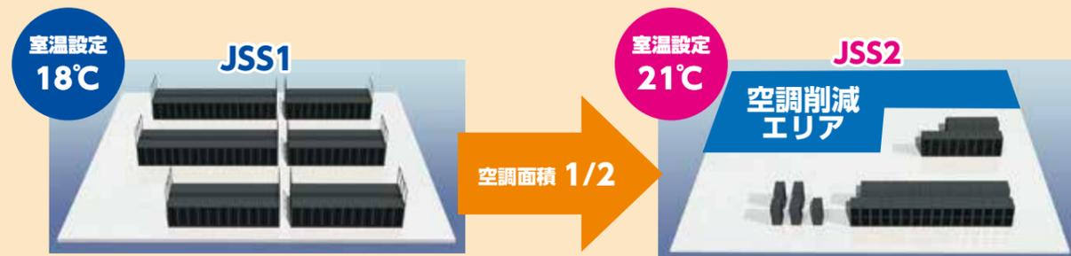
エネルギー消費削減の一環として、設置システムに合わせて計算機ルームの空調エリアを削減しました。併せて、機器への影響を確認しながら継続的に空調温度設定を見直し、現在はJSS1 当時よりも高いセ氏21度に設定しています。
