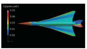
図2 極超音速実験機 圧力係数分布(マッハ5, 迎角15度) : Hypersonic Experimental Aircraft, Mach number (Mach 5, AOA=15deg)
