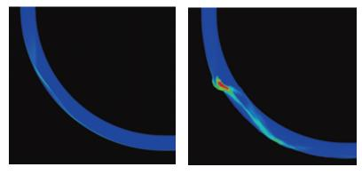
図1 正方形断面 90°ベンドにおける気流に働く粒子の抗力分布 :(左)エロージョン前,(右)エロージョン後 : Drag Force contours at Midspan of 90° Bend with square section : (left) Before Erosion, (right) After Erosion
