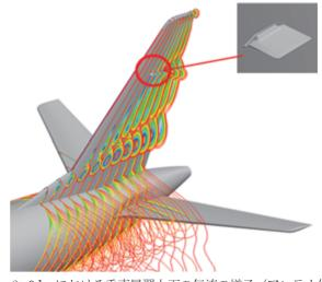
図1  $\beta$ >0degにおける垂直尾翼上面の気流の様子(アンテナ付) : Flow on the vertical tail with sideslip angle(with antenna).
