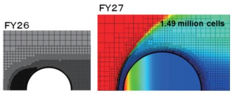
図1 解適合格子による球の熱流束評価 : Heat flux estimation for sphere by using adaptive mesh refinement.
