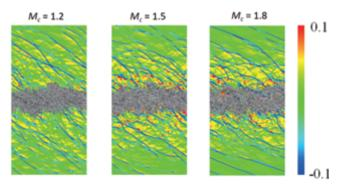
図1 圧縮性混合層から発生する音響波に対するマッハ数依存性 : Mach number dependence on acoustic waves from compressible mixing layer.
