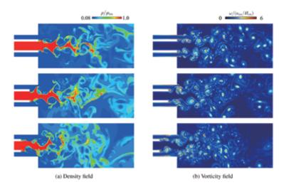
図1 超臨界平行噴流に対するリセス形状の効果.上からリセスなし、 短リセス形状,長リセス形状.左列は密度,右列は絶対渦度.
