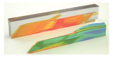
図1 スクラムジェットエンジンCFD三次元可視化結果を三次元プリンタにて出力支援 : Support for scramjet engine CFD 3D visualization by means of 3D printer
