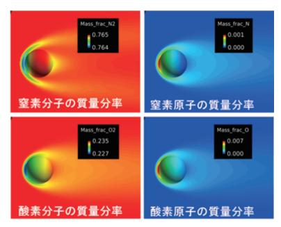
図1 4温度モデルにおける球体周りの化学組成の流れ場の様子 : Flow Field around sphere in Four Temperature model
