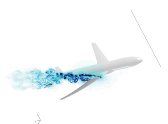
図1 バフェット解析の例 : Example of Tail Buffet Analysis
