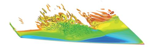
図1 遷音速バフェットの乱流渦構造 : Structure of turbulent eddy of transonic buffet
