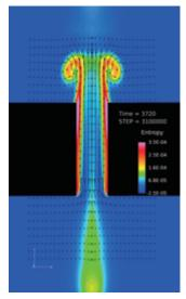
図1 音波入射により吸音ライナー孔に発生する粒子速度 : Particle velocity of sound absorption panel
