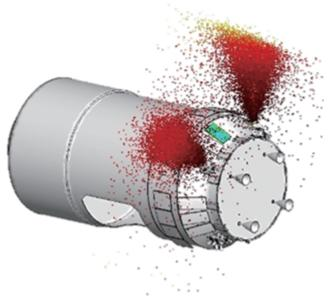
図 1 HTV RSC スラスタ解析 : Plume simulation of RCS thrusters of HTV
