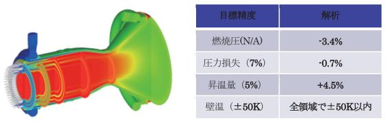
図1 LE-5B エンジンでの再生冷却性能予測検証 : Validation results of regenerative cooling performance of LE-5B engine
