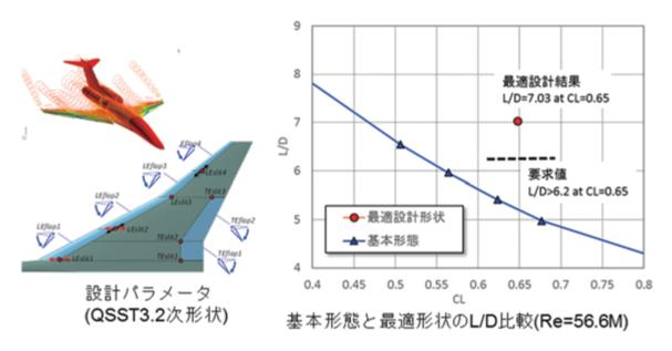
図1 QSST3.2 次形状高揚力装置最適設計による揚抗比改善: Improvement of the lift-to-drag ratio by the HLD optimization on QSST
