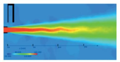
図 2 音響加振によるジェットの変化 : Excitation of a jet flow with sound
