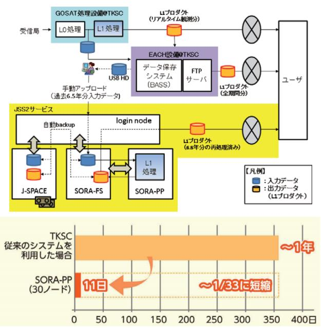
再処理時のシステム間データフローと処理時間改善結果
