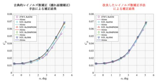
図1 JAXA 2m×2m 遷音速風洞(Re=2e6)および National Transonic Facility(Re=5e6~30e6) で取得した NASA-CRM 風洞試験模型の抵抗係数データへの Re 数補正適用結果 : Results of Reynolds number correction for NASA-CRM model drag coefficient at JAXA 2m×2m Transonic Wind Tunnel (Re=2e6) and National Transonic Facility (Re=5e6~30e6)
