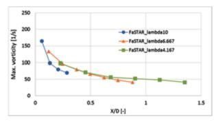
図 2 最大渦度の推移 :Maximum vorticity of tip vortices
