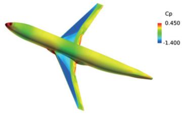
図1 自然層流設計を適用した参照機体形状 : Wing-body configuration applied natural laminar flow wing technology.
