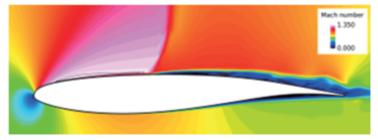
図1 OAT15A翼型のバフェット解析 : Buffet analysis of OAT15A airfoil
