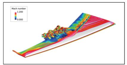
図2 NASA-CRM翼のバフェット解析 : Buffet analysis of NASA-CRM wing
