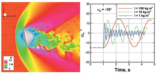
図2 火星大気圏突入カプセルに対する M = 1.6 での動安定解析の結果 (左:瞬時のマッハ数分布,右:カプセル迎角の時間変化)
