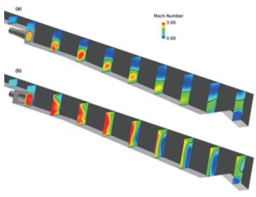
図1 エジェクタ内のマッハ数分布 (a)初期形状 (b)改良形状 : Mach Number Distribution (a)Initial (b)Improved
