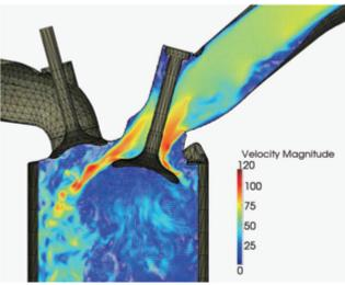
図1 自動車エンジン筒内定常流動解析 : Steady State Flow Simulation of Automotive Engine Chamber
