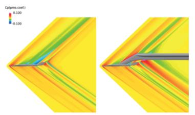
図1 小型超音速旅客機第3.3次概念設計形状 風試検証用解析結果 (左:模型支持なし/右:模型支持あり)
