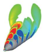
図1 迎角60度における細長物体周り渦度分布 : Vorticity Profiles around Slender Body at AOA=60°
