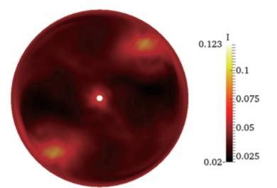
図1 歳差球体内に維持される非ニュートン流体の乱流強度(赤道面). : Turbulence intensity of turbulence of a non-Newtonian fluid confined in a precessing sphere.
