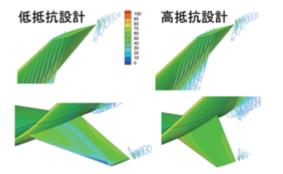
図2 小翼最適での翼端渦の変化 メインウィングレット周り(上図)とsplit wingletの小翼周り(下図) : Comparison of wing tip vortices around main winglets (upper subfigures) sub-winglet (lower subfigures)
