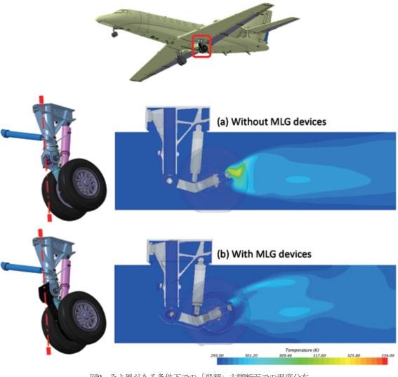
図2 そよ風がある条件下での「飛翔」主脚断面での温度分布 :(a) 主脚デバイスなし;(b) 主脚デバイスあり : Temperature distributions on a cross-section through the "Hisho" main landing gear (MLG) under a breeze condition (a) without and (b) with an MLG device.
