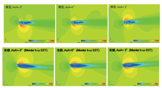
図1 4桁橋梁断面周りの流れ場の平均速度分布 : Mean velocity contour around a 4-girder bridge
