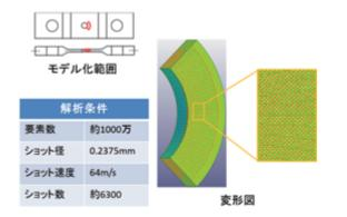
図 2 ショットピーニング解析モデル : Shot peening analysis model
