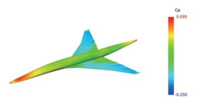
図1 自然層流翼設計を適用したQSST : QSST applied natural laminar flow wing design
