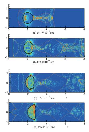
図1 マッハ6の衝撃波通過後の空気—水柱のシュリーレン結果(3001×751 格子点). : Numerical density schlieren images of Mach 6.0 air-water shock-cylinder interaction problem(3001×751 grid ponts).
