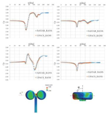
図1 RLGの表面圧力分布 : Surface Presser Distribution of RLG
