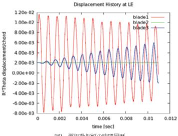
図1 翼振動振幅の時間履歴 : Time history of blade oscillation amplitude
