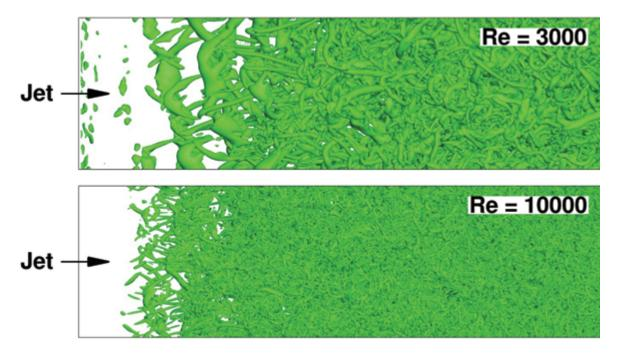
図1 Re = 3000 および 10000 での DNS による第二不変量の等値面 : Top view of positive Q criteria for the DNSs at Re = 3000 and 10000.
