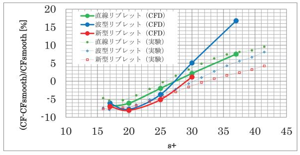
図1 JAXA 独自形状である新型リブレット(特許出願中)と従来の直線リブレット・波型リ ブレットとの比較
