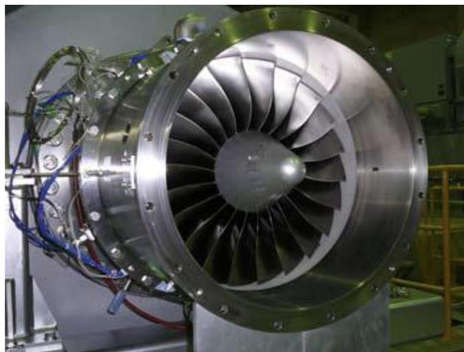
図1 JAXA遷音速ファン試験機
