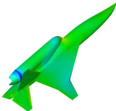
図1 機体尾部とノズル排気の干渉問題解析結果 (迎角 $2^\circ$ )
