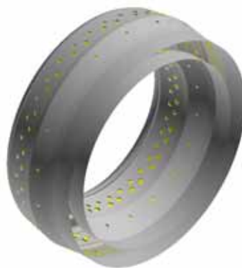
図1 フルアンニュラー燃焼器の外壁
